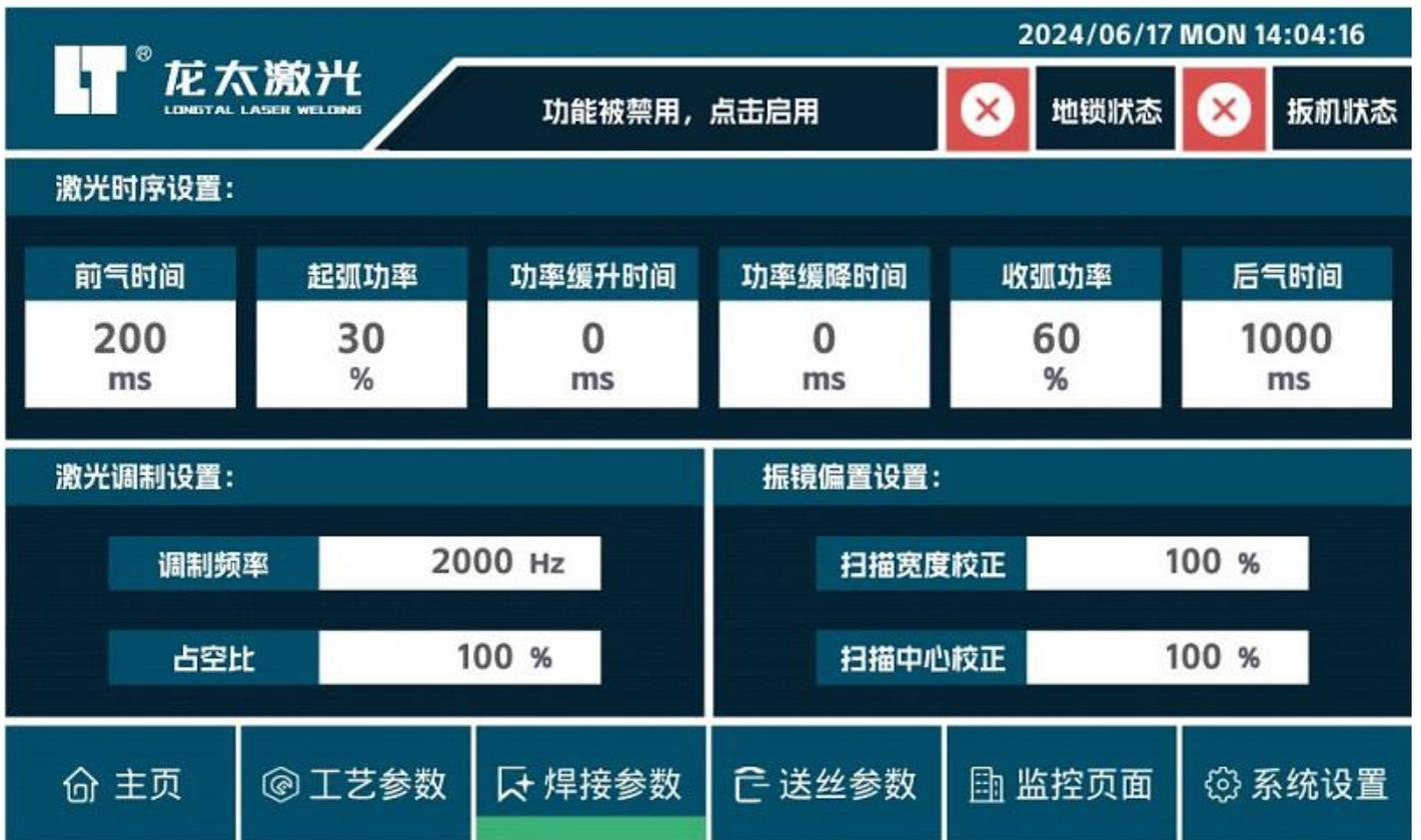
①焊接参数页面包含焊接时参数设置、调制设置以及激光中心偏移。
