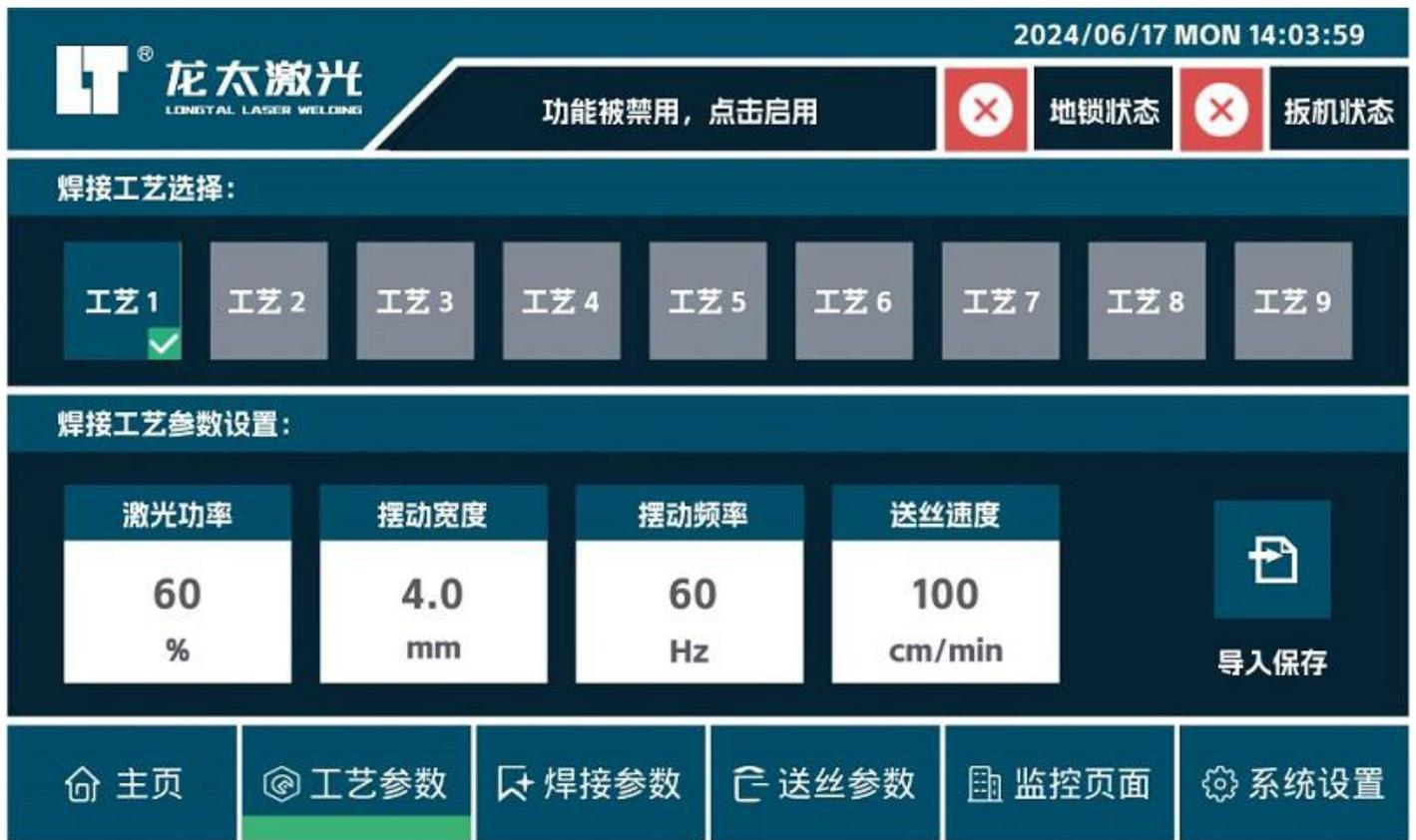
①工艺界面包含调试的工艺参数，点击框可修改，修改完毕后点击导入保存，然后保存在快捷工艺，使用时再次导入即可（修改-导入保存）。
